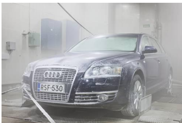
Abbildung 4: Prüfung der Kälteeigenschaften mit Dieselfahrzeugen in einer Klimakammer
